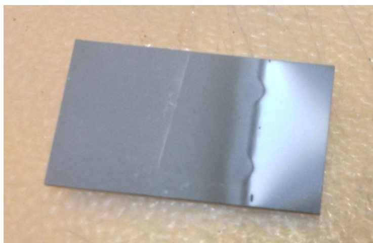
Рис. 4. Образец пленки Ni на корундовой керамике
